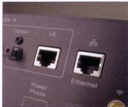
Zwei RJ-45-Buchsen gibt's. Eine stellt die LAN-Verbindung her, die andere ist der sogenannte i2S-Eingang, der zukünftig noch Verwendung finden wird
