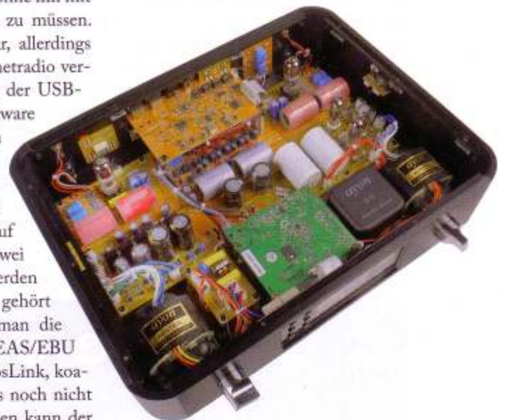
Kein Verstärker, sondern ein Netzwerkplayer. Stabile Stromversorgung, resonanztotes Gehäuse, erlesene Bauteile – so baut man das!
