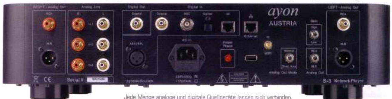
Jede Menge analoge und digitale Quellgeräte lassen sich verbinden. Per USB kann man außerdem eine Festplatte anschließen
