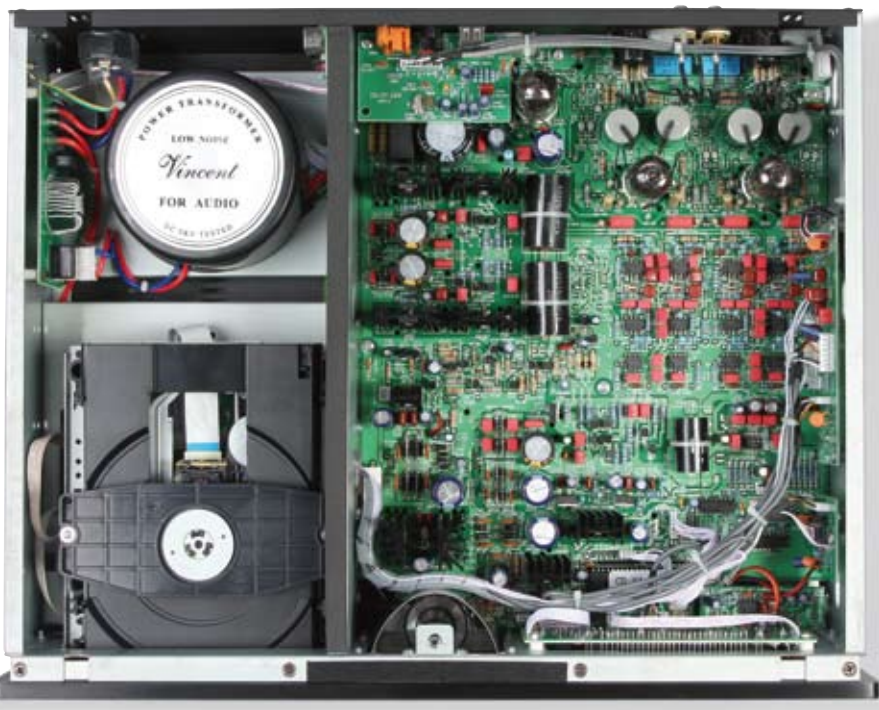
Die mit teuren Folienkondensatoren ungewöhnlich üppig bestückte Platine im Vincent erinnert an Studio-Equipment aus den 1960er Jahren. Der D/A-Wandler-Baustein hockt vorne rechts.
