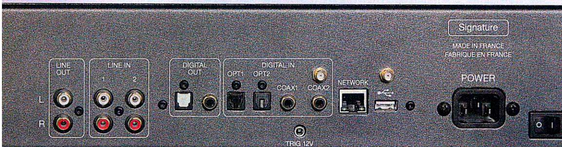
Die beiden Line-Eingänge sowie der mithilfe eines Widerstandsnetzwerkes arbeitende, damit analoge Pegelsteller des Atoll gewährleisten einen puristisch analogen Signalweg, etwa für Phonostufen.
