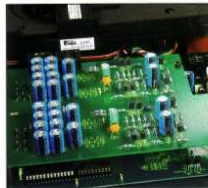
Aufgesessen: Die Ausgangsstufe hockt auf einer aufgestockten Platinen-Etage.
