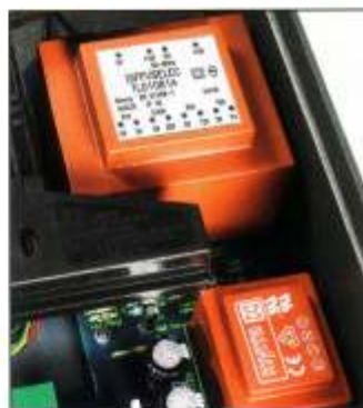
Zwei Mann vor: Eigene Netztrafos versorgen Laufwerk und Ausgang.
