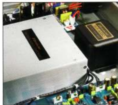
Still gestanden: Das Laufwerk ruht umfassend gekapselt in einem eigenen Gehäuse.
