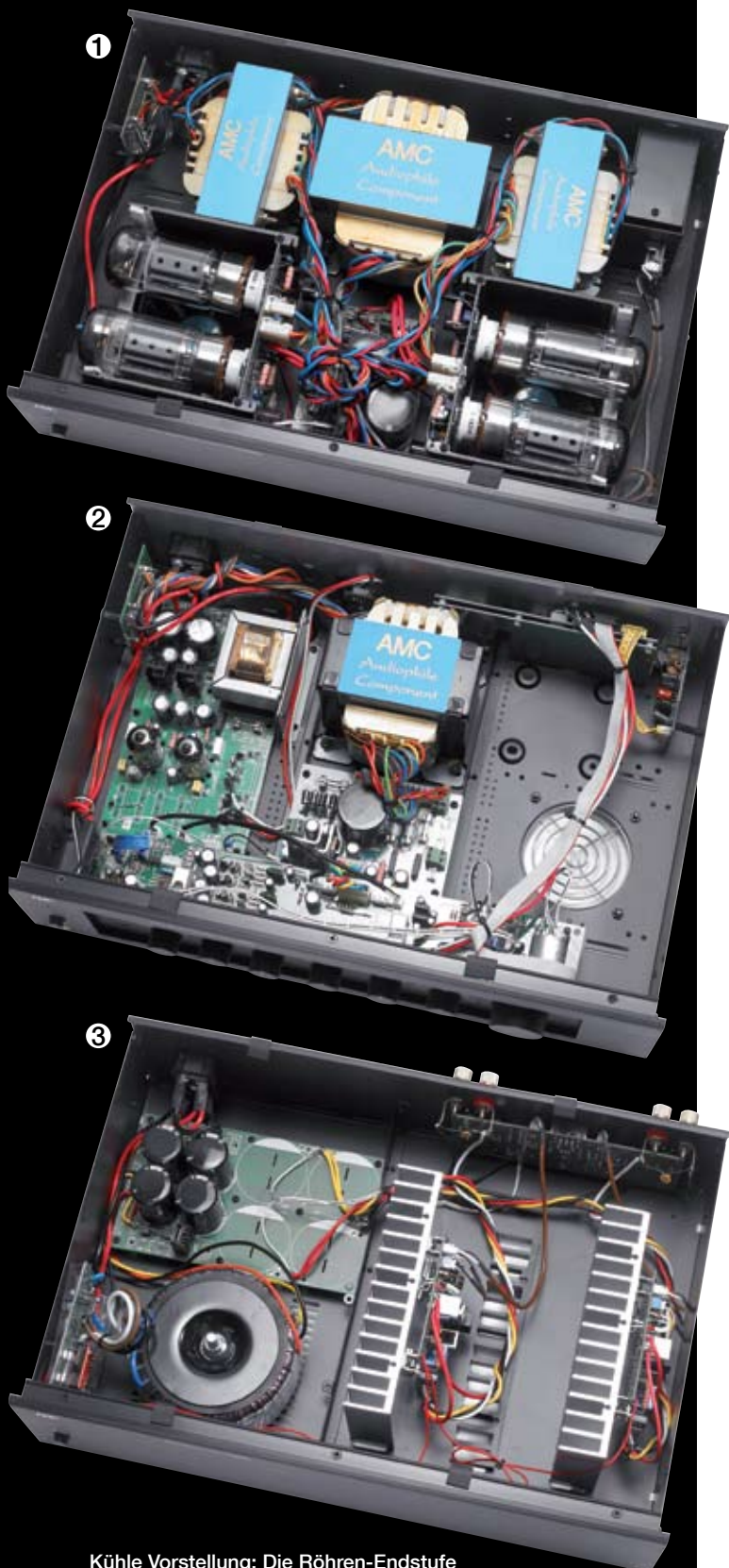
Kühle Vorstellung: Die Röhren-Endstufe 2100 (oben) mit quer liegenden Leistungs- röhren 6550 (1) und die Vorstufe 1030 Mk2 basieren beide auf dem CVT-(Cool Valve Technology-)Prinzip, das per Ventilator (2) die Hitze reguliert und so die Röhren verzerrungsfrei spielen lässt. Die Transistor-Endstufe 2100 Mk2 (unten) benötigt weniger Kühlung; ihren Sanken- Transistoren (3) reichen die Kühlrippen gegen Überhitzung.
